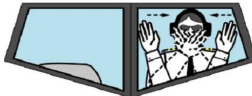
4. Bremsklötzte entfernen: Die Arme werden vor dem Gesicht gekreuzt und mit den Handflächen nach außen seitlich ausgestreckt.
