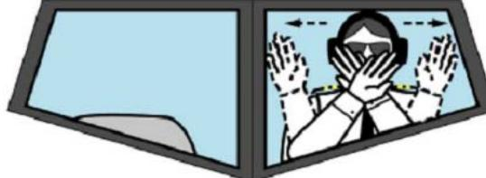
5. Fertig zum Anlassen der Triebwerke: Die Anzahl der ausgestreckten Finger einer Hand gibt die entsprechende Nummer des anzulassenden Triebwerks an.
